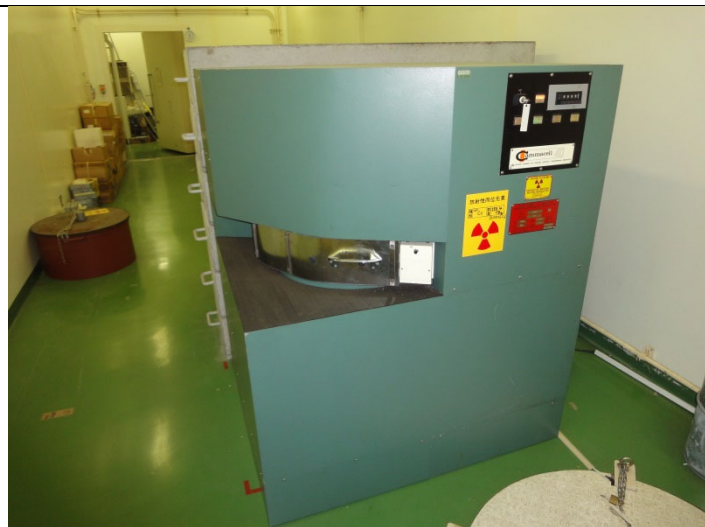
\gamma 線照射装置 ( ^{137}\text{Cs} 、155.4TBq、46Gy/h)
