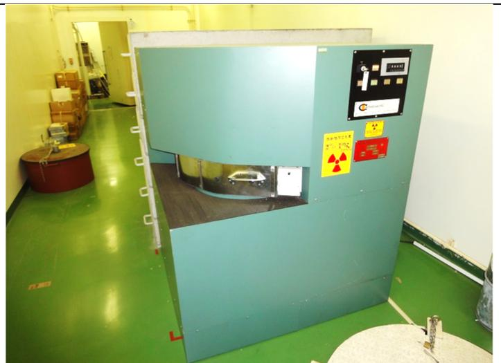
**$\gamma$  線照射装置 ( $^{137}\text{Cs}$ 、155.4TBq、46Gy/h)**
