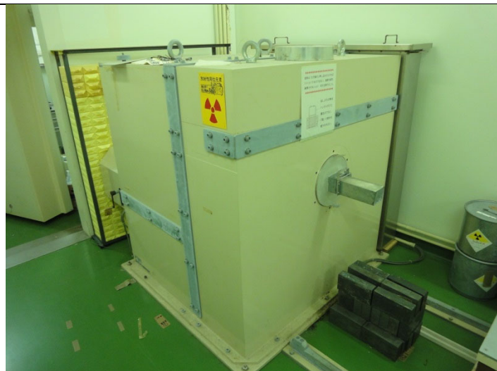
中性子照射装置 ( ^{241}\text{Am-Be} 、3.26TBq)
