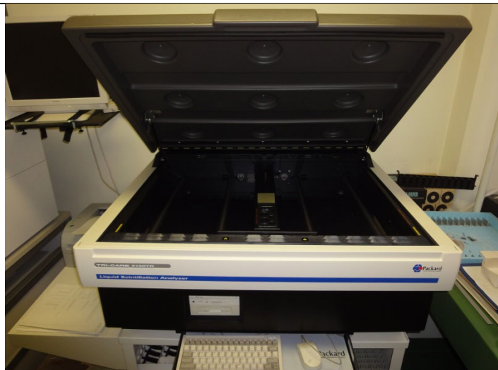
液体シンチレーションカウンター パーキンエルマー Tri-Carb 4810TR \beta 核種を含む試料の測定に使用できます。
