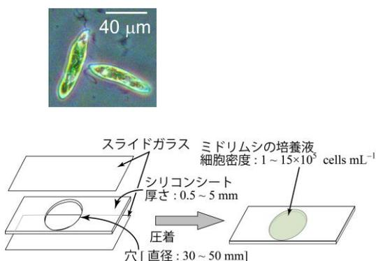
Fig. 1 試料作成の概念図
