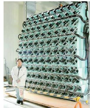
図1 マルチファン型風洞
