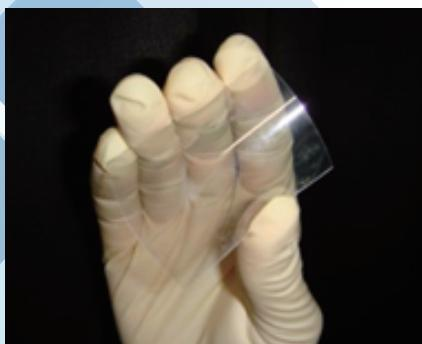
フレキシブル透明電極の作製とタッチパネルの応用
