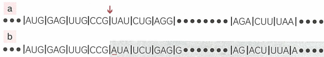
図9.3 ● 塩基挿入によるフレームシフト 矢印の部位にAが挿入され、それ以降の枠がずれている。
