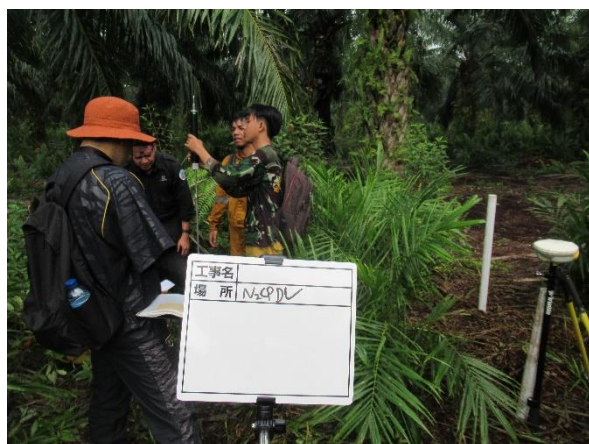
写真 1. 貫入の様子（左；土検棒、右；ポータブルコーン貫入試験）
