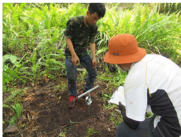
写真 1. 貫入の様子（左；土検棒、右；ポータブルコーン貫入試験）
